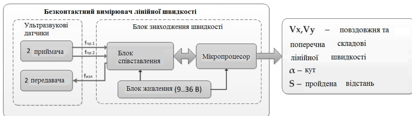
Рисунок 1.7 - Структура безконтактного вимірювача [8]
