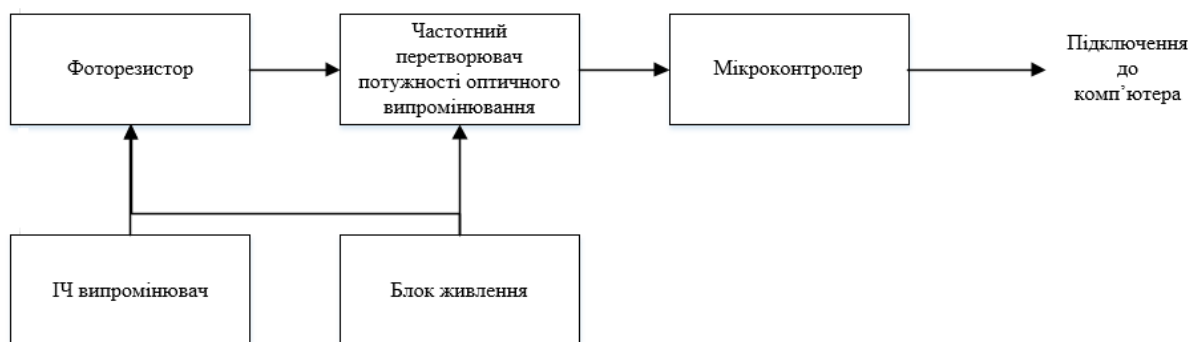
Рисунок 2.1 – Структурна схема вимірювача оптичного випромінювання на основі каскаду Дарлінгтона
