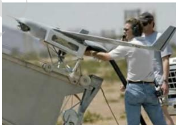
Рисунок 1.2б - Запуск за допомогою стартової катапульти
