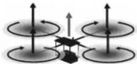
Рисунок 1.6 - Схема багатогвинтового вертольоту (мультикоптера)
