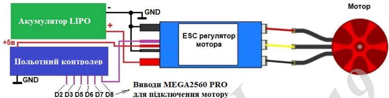
Рисунок 4.7 - Підключення мотора до польотного контролера
