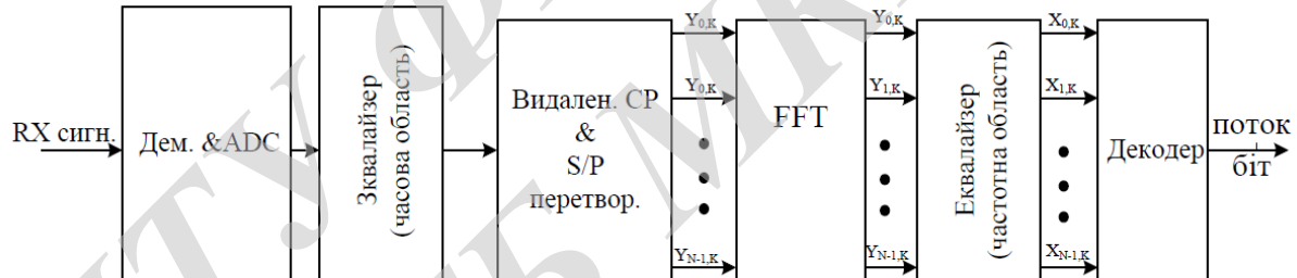
Рисунок 4.4 – Приймач OFDM сигналів
