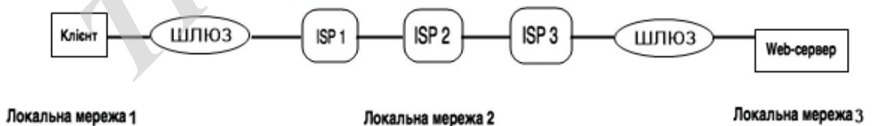
Рисунок 3.11 – З'єднання між клієнтом і сервером
