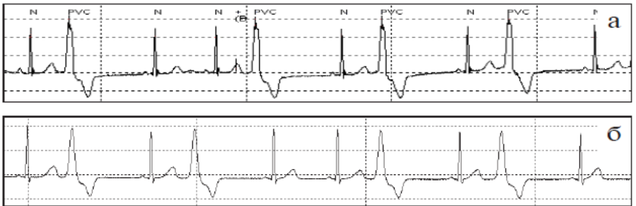
Рисунок 3.4 – Реальна (а) і макетна (б) ЕКГ з екстрасистолами
