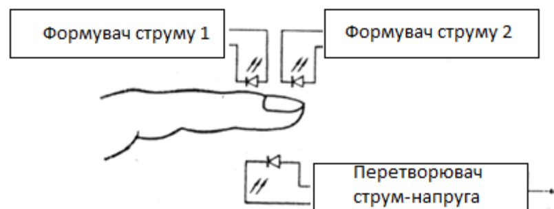
Рисунок 3.6 – Схема розташування випромінювачів та фотоприймача при вимірюванні ступені насичення крові киснем
