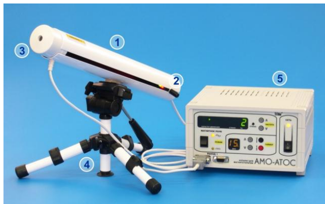
Рисунок 1.7 - Загальний вигляд апарату "АМО-АТОС": 1 - Процедурний тубус, 2 - Випромінювач фотостимулів (всередині тубуса), 3 - Випромінювач магнітного поля, 4 - Шток фіксації процедурного тубуса, 5 - Електронний блок апарату "АМО-АТОС" [5].
