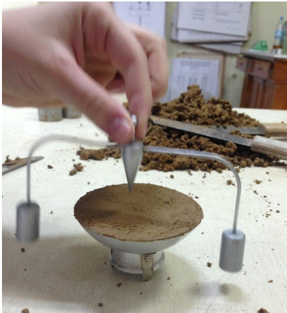
Рис.2 – Визначення вологості ґрунту на межі текучості
