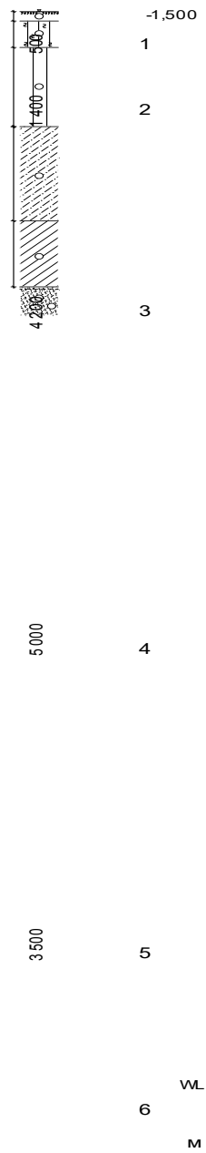
Рисунок 2.2 – Інженерно-геологічний розріз по поперечнику будівлі.
