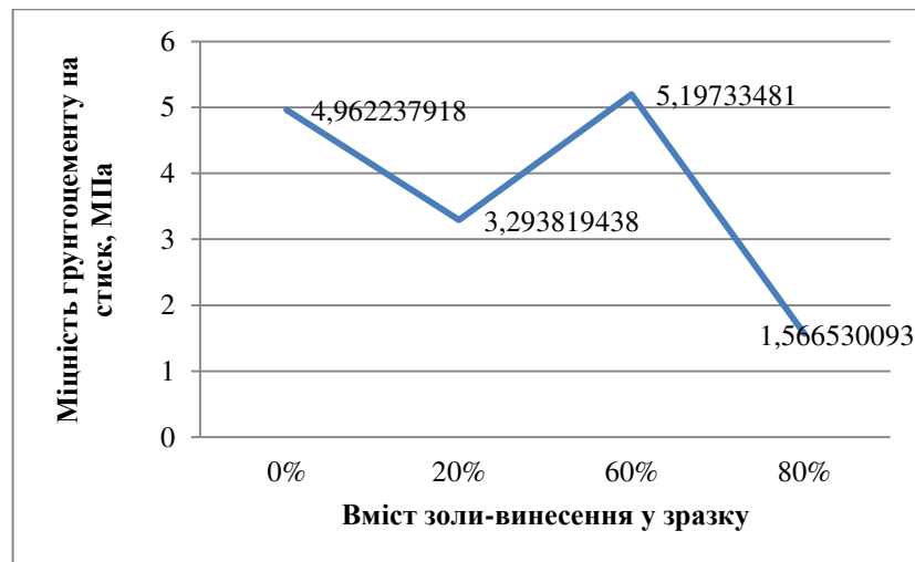
Рисунок 1.24 – Залежність міцності ґрунтоцементу на стиск від вмісту мінеральної добавки
