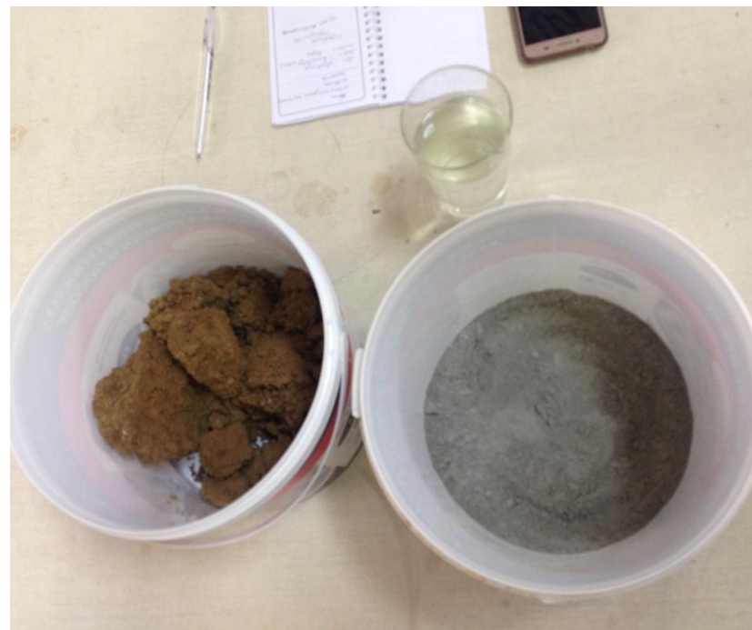
Рис.1 –Матеріалами для виготовлення ґрунтоцементу
