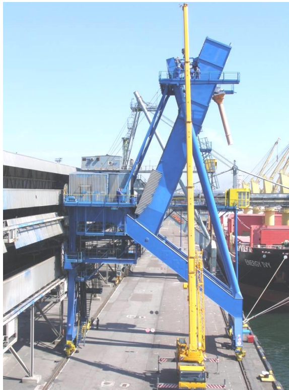
Рис. 2.2 – Вид суднонавантажувача з південного боку при фіксації стріли в крайньому верхньому положенні
