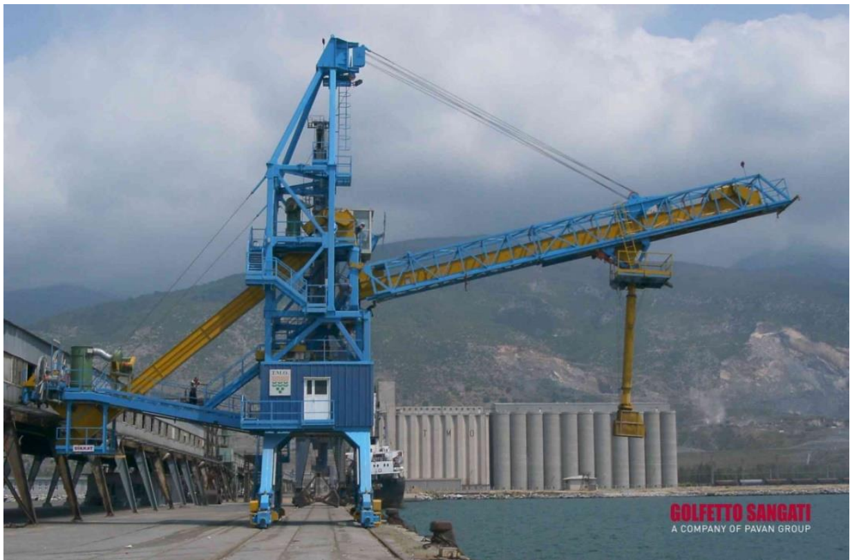
Рис.1.16 – Суднонавантажувач зі стрілою у вигляді ферми
