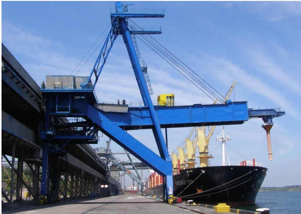
Рис. 1.5 – Суднонавантажувач № 7.1 фірми «POHLING-HECKEL-BLEICHERT» на території Одеського припортового заводу
