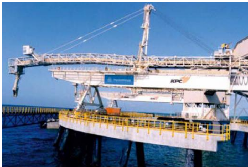
Рис 1.9 – Загальний вигляд суднонавантажувача радіального руху фірми КРС в порту Швеції
