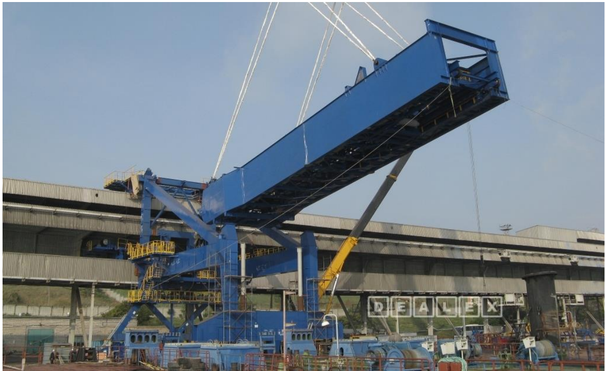
Рис. 1.17 – Суднонавантажувач зі стрілою коробчастого перерізу
