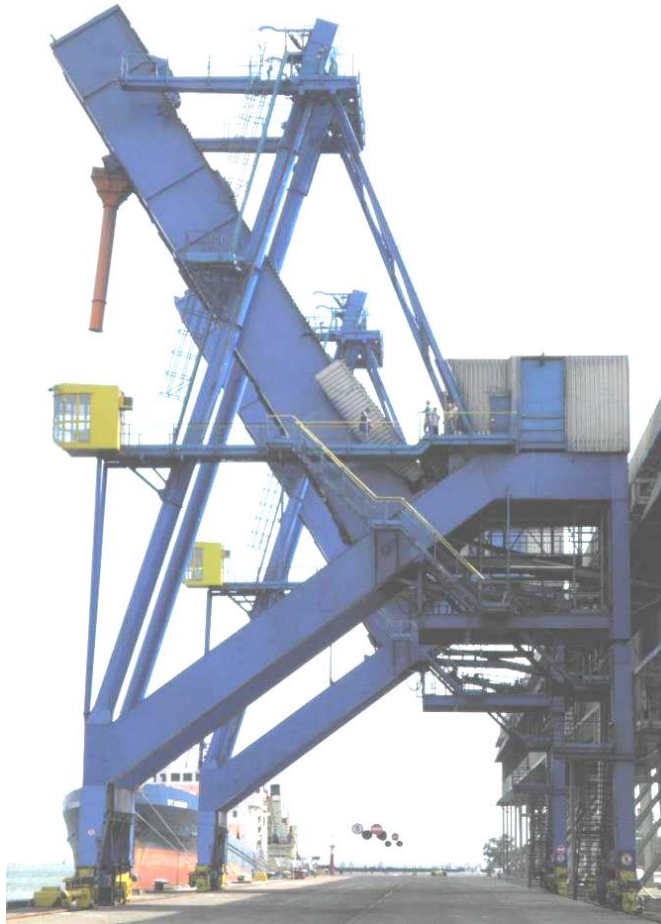
Рис. 2.4 – Вигляд суднонавантажувача № 7.1 з північного боку (висувна частина всередині стріли, стріла – в верхньому робочому положенні)
