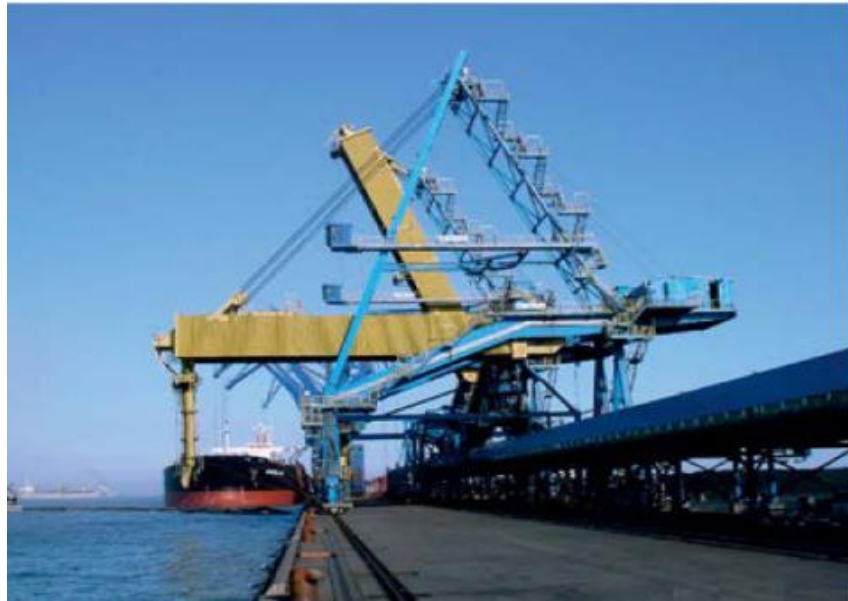
Рис. 1.11 – Портальні рейкові навантажувачі: а) схема; б) загальний вигляд суднонавантажувача фірми «POHLING-HECKEL-BLEICHERT» в порту м. Южне Одеської області
