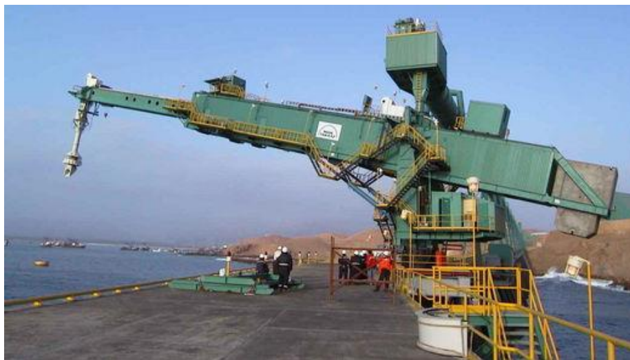
Рис. 1.7 – Загальний вигляд стаціонарного суднонавантажувача фірми «Тепова»
