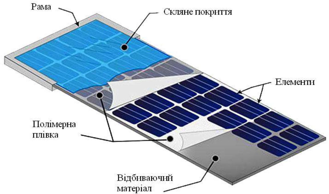
Рисунок1.1. Склад сонячної панелі
