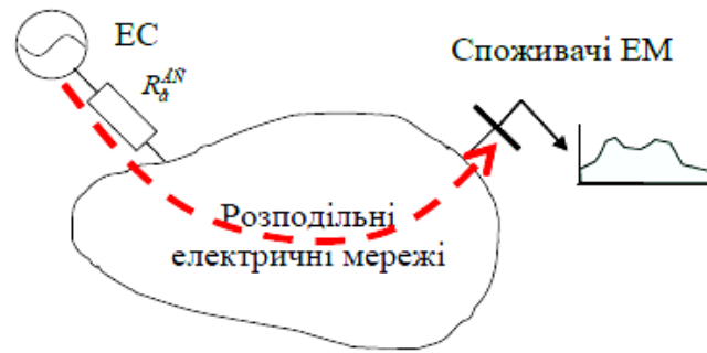
Рисунок 2.1 – Централізоване електропостачання від крупних електричних станцій
