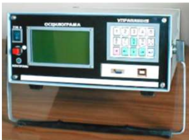
Рисунок 5.2 – Зовнішній вигляд розробленого пристрою для контролю часових характеристик реле
