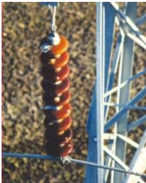
Рисунок 1.3 – Руйнування спідниці ізолятора дугою
