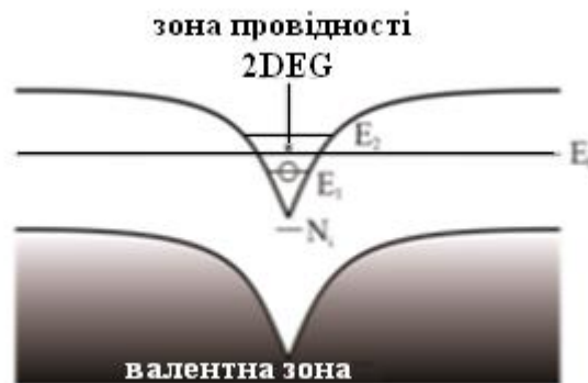
Рисунок 1.5 – Енергетичні зони в дельта-легованій напівпровідниковій структурі
