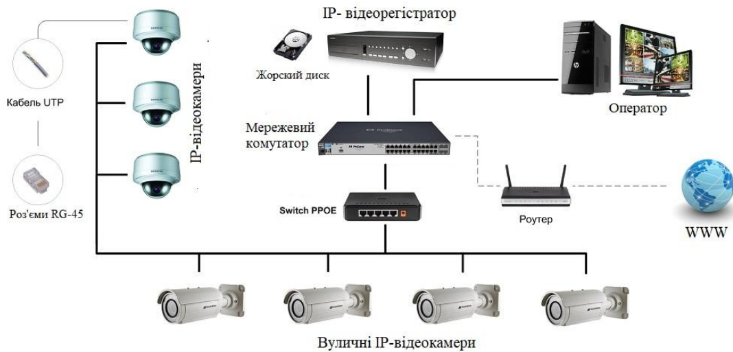
Рисунок 1.2 – Типова система IP-відеоспостереження
