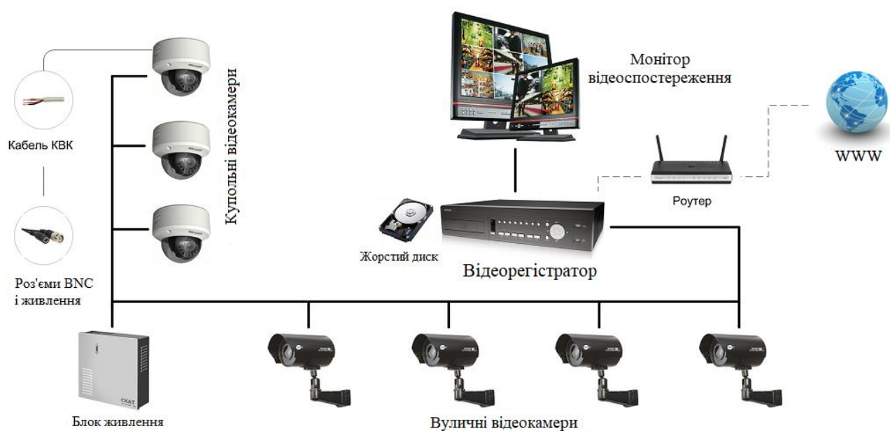
Рисунок 1.4 – Типова система аналогового відеоспостереження
