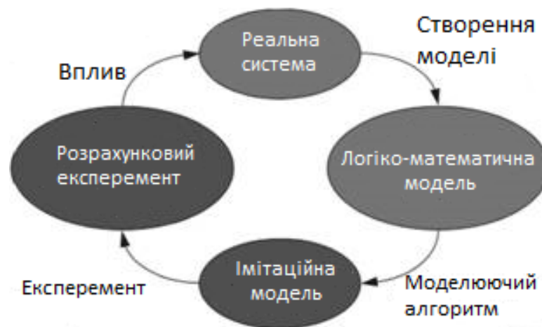
Рисунок 2.1 – Схема циклічного процесу імітаційного моделювання
