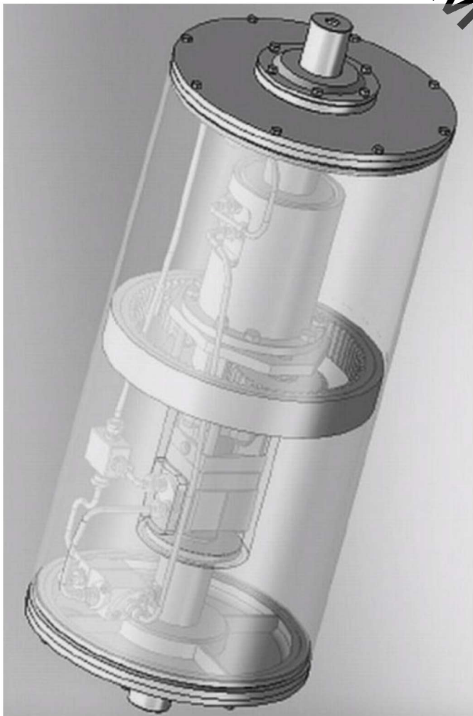
Рисунок 3 – Привід з пристроєм керування на основі двокаскадного клапана непрямого дії
