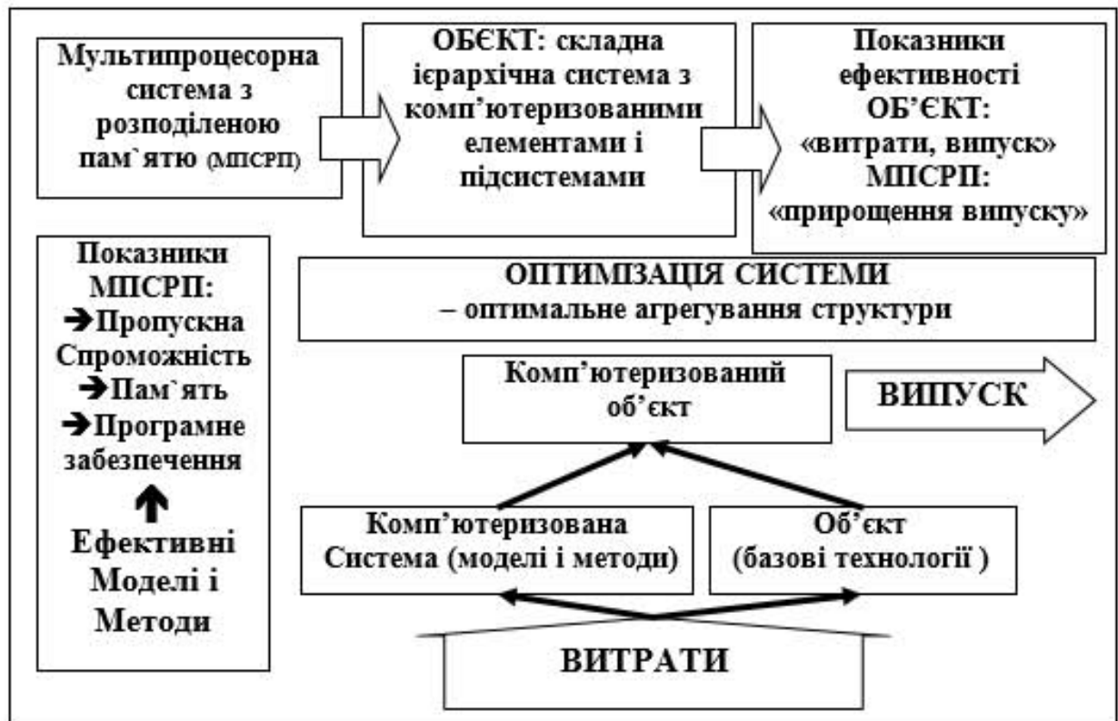
Рисунок 3.9 - Структурна схема розробки: комплекс засобів аналізу ефективності мультипроцесорних систем
