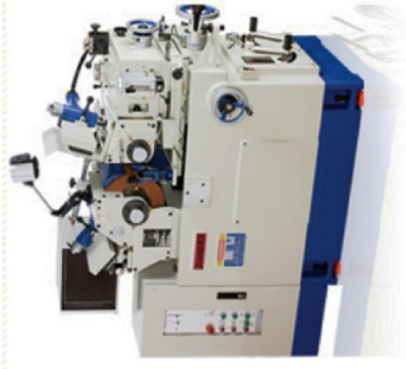
Рисунок 4 – Безцентровий-шліфувальний верстат моделі Jointner JHC-128M/12S
