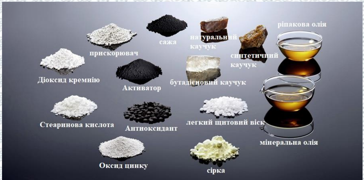
Рисунок 4.5 – Інгредієнти сучасної гумової суміші для виготовлення шин
