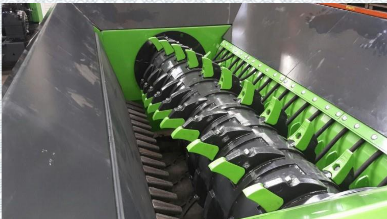
Рисунок 4.11 – Роторні млини для подрібнення шин
