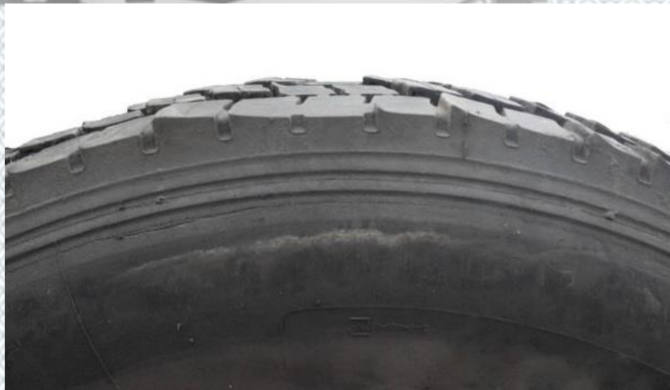
Рисунок 3.4 – Пилкоподібний знос шини
