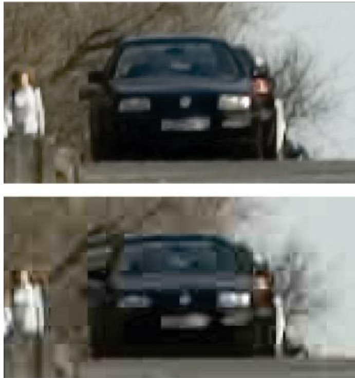
Рисунок 1.3.2 – Артефакти ущільненого в 30 разів JPEG зображення.
