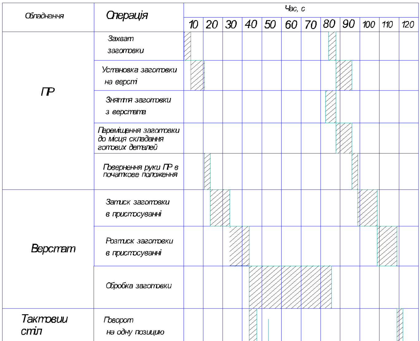
Рисунок 2.21 – Циклограма функціонування РТК
