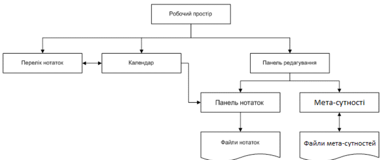
Рисунок 3.12 – Структура програмної моделі керування електронними нотатками
