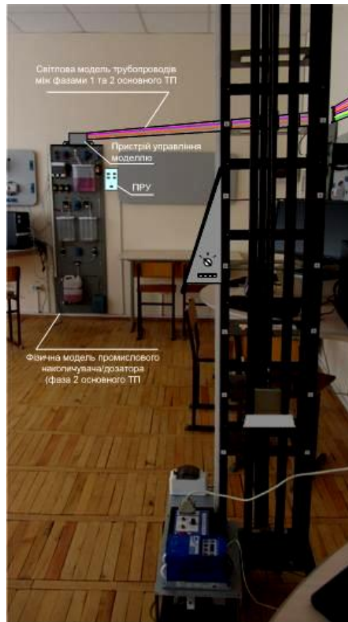
Рисунок 1.13 - Імітаційна модель рідких матеріальних потоків (трубопроводів) між фазами 1 і 2 основного ТП
