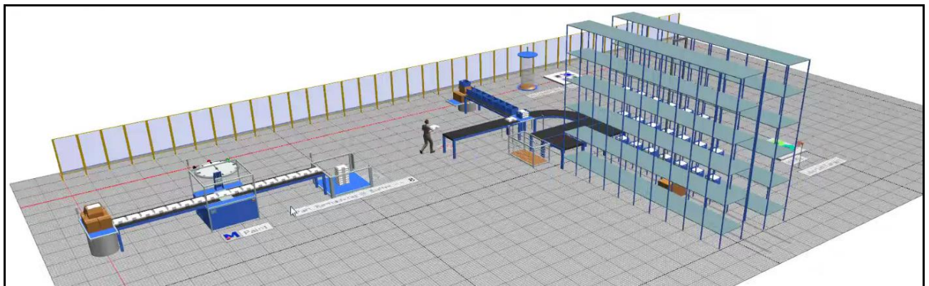
Рисунок 2.14 – Приклад моделювання автоматизованого виробничого складу
