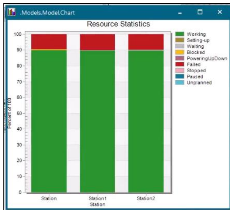
Рисунок 2.7 – Діаграма роботи вдосконаленої виробничої лінії
