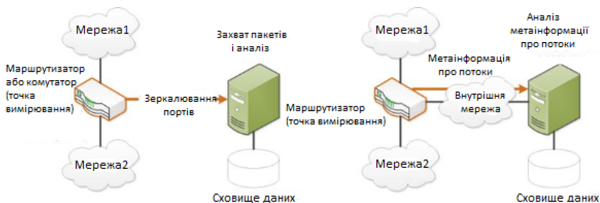
Рис. 2.4 - Відмінності типових схем packet (зліва) і flow-based (праворуч) аналізу.
