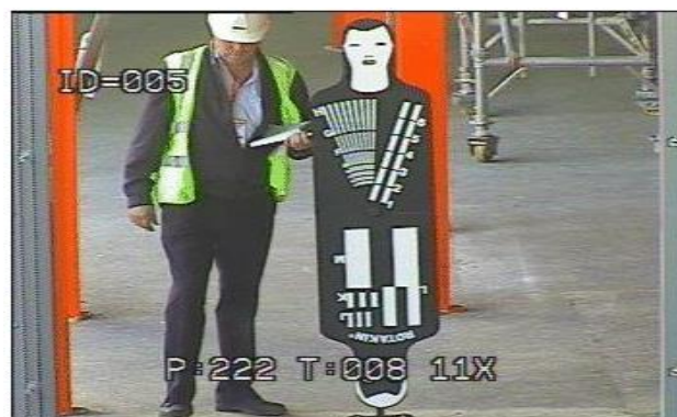
Рисунок 2.5.-Тестовий об'єкт Rotakin CCTV в роботі
