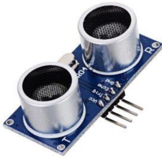
Рисунок 2.8 – Ультразвуковий датчик HC-SR04
