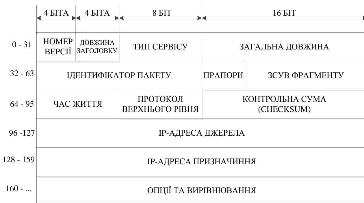
Рисунок 1.7 – Структура ІР-пакета
