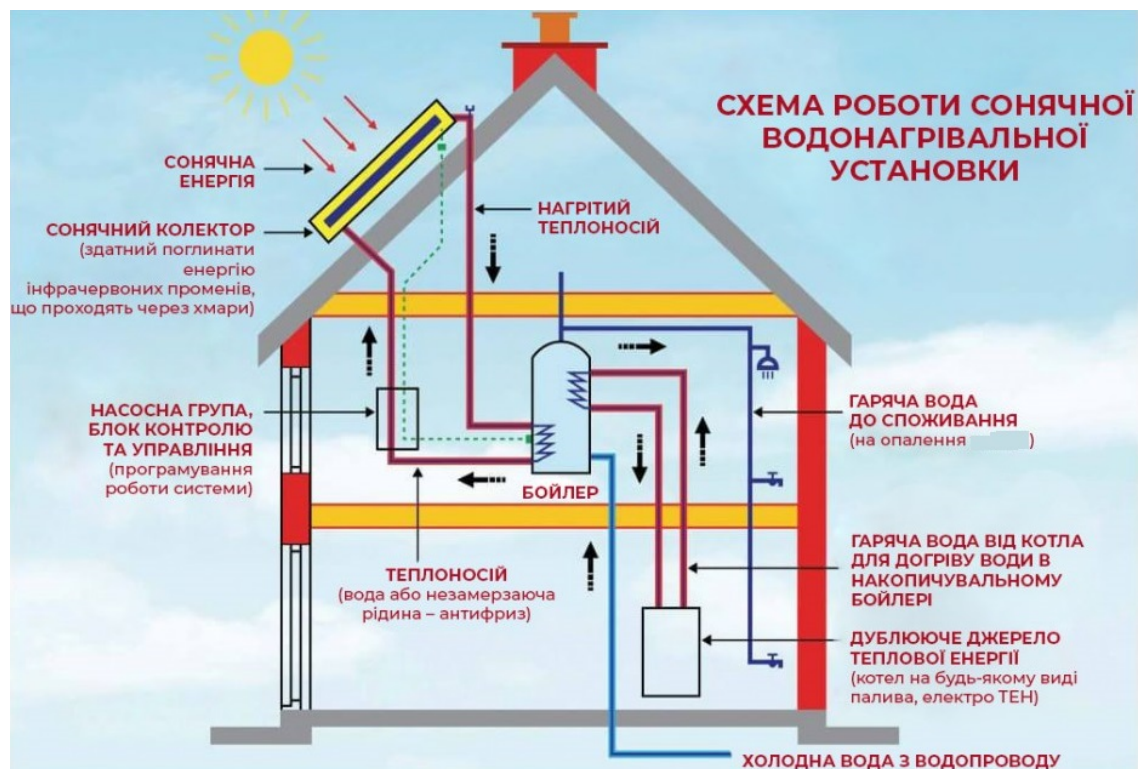
Рисунок 1.2 – Схема роботи системи опалення з сонячними колекторами
