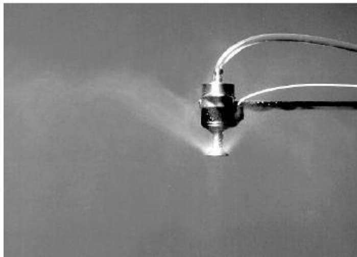
Рис. 1.7 – Розпилення факела у вигляді зворотного конуса
