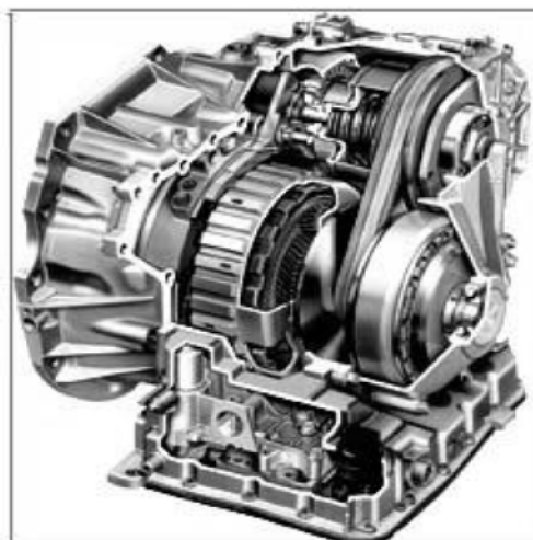
Рисунок 1.2 - Загальний вигляд клинопасового варіатора у виконанні привода автомобіля
