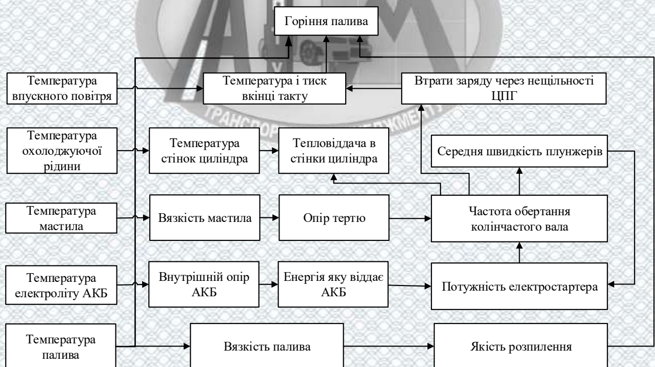
Рисунок 1.4 - Схема впливу керованих факторів на займання палива в циліндрах дизельного двигуна
