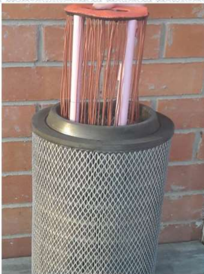
Рисунок 3.19 - Дослідний зразок електронагрівального елемента для автомобіля Урал-4320
