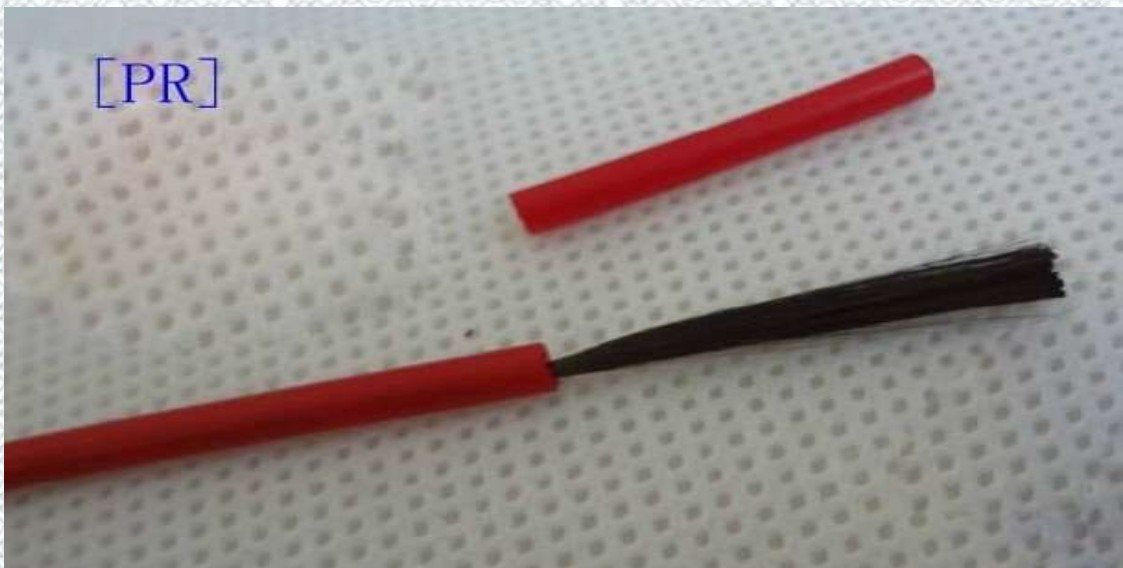
Рисунок 3.17 - Вид струмопровідної жили з вуглецевого волокнистого матеріалу з ізоляцією з кремнійорганічною гумою
