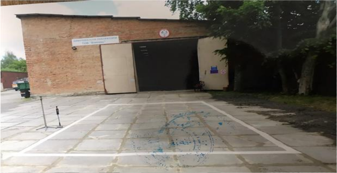
Рисунок 1.5 – Майданчик для вимірювання шуму, створюваного колісними ТЗ в нерухомому стані (при працюючому двигуні)
