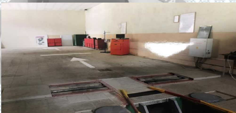
Рисунок 1.3 – Роликівий стенд для перевірки гальмівних систем автомобілів фірми «ENER-GOTEST» MiDi 13/30 і майданчик для контролювання зовнішніх світлових приладів
