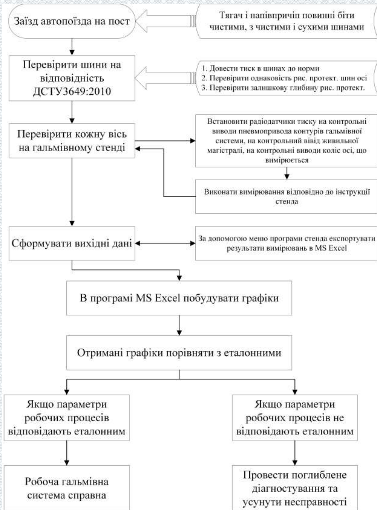
Рисунок 4.7 – Алгоритм діагностування робочої гальмівної системи сідлового автопоїзда на гальмівному стенді
