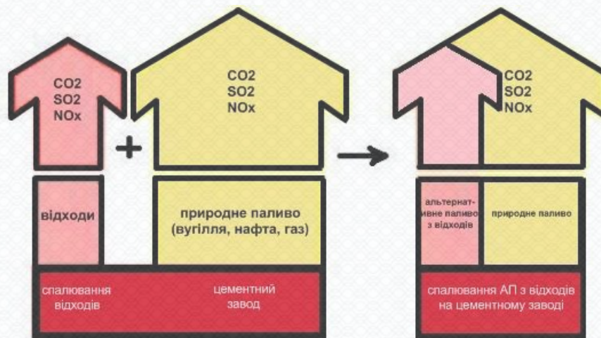
Рисунок 4.3 - Екологічне зрівняння ефективності використання відходів на сміттєспалювальному заводі та їх використання як альтернативного палива в цементних печах
