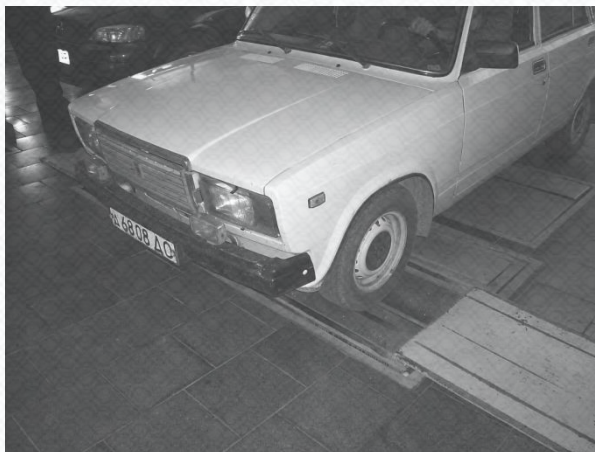
Рисунок 4.10 - Лінія діагностики ходових якостей з автомобілем, що досліджується
