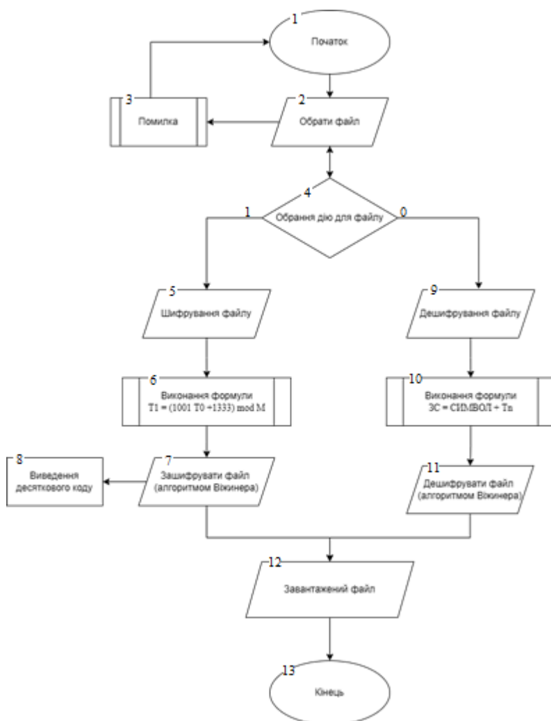
Рисунок 3.3 – Блок-схема алгоритму роботи головного модуля вебсайту
