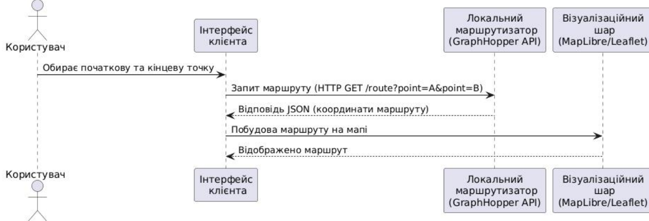
Рисунок 2.3 - UML-діаграму послідовності, що ілюструє обмін повідомленнями між основними компонентами
