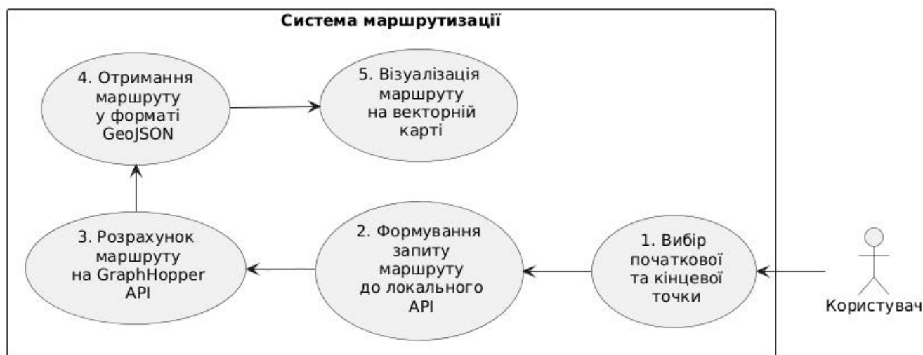
Рисунок 2.2 - UML діаграма використання, що описує взаємодію користувача з системою побудови маршрутів у режимі офлайн
