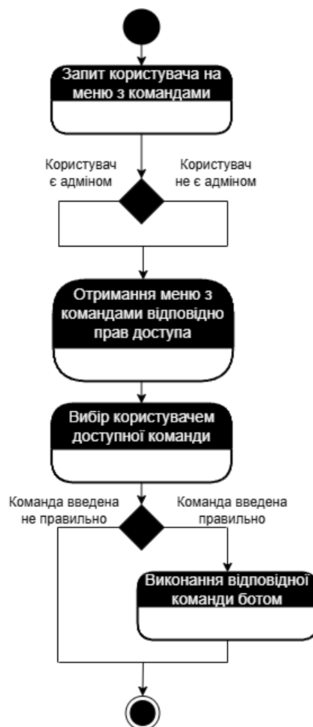
Рисунок 2.2 – Загальна модель взаємодії бота та користувача
