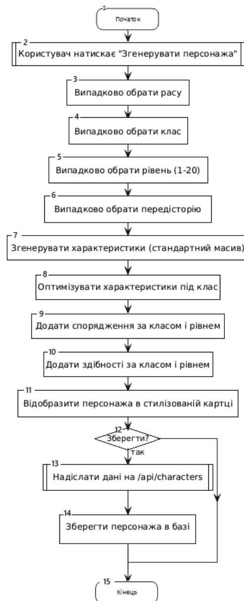
Рисунок 2.3 – Блок-схема алгоритму генерації випадкових персонажів
