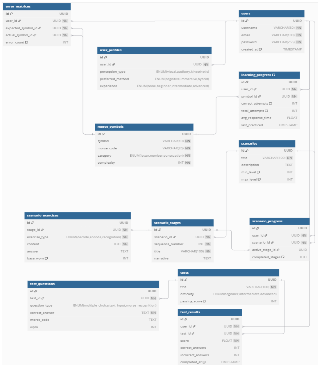
Рисунок 3.1 – Схема бази даних застосунку для вивчення абетки Морзе
