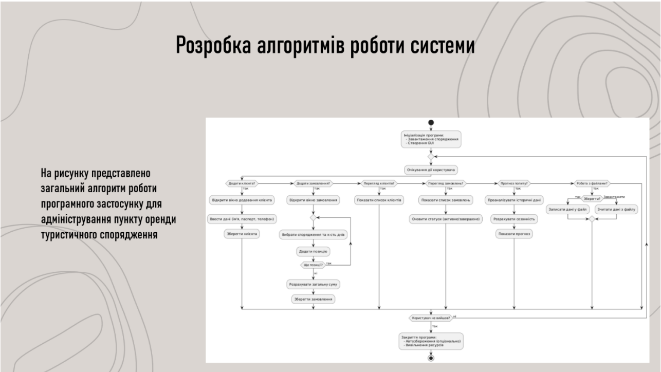
Рисунок Г.6 – Розробка алгоритмів системи – Загальний алгоритм роботи програмного застосунку
