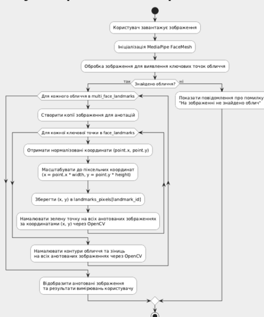
Рисунок Г.15 – Діаграма алгоритму обробки координат ключових точок
