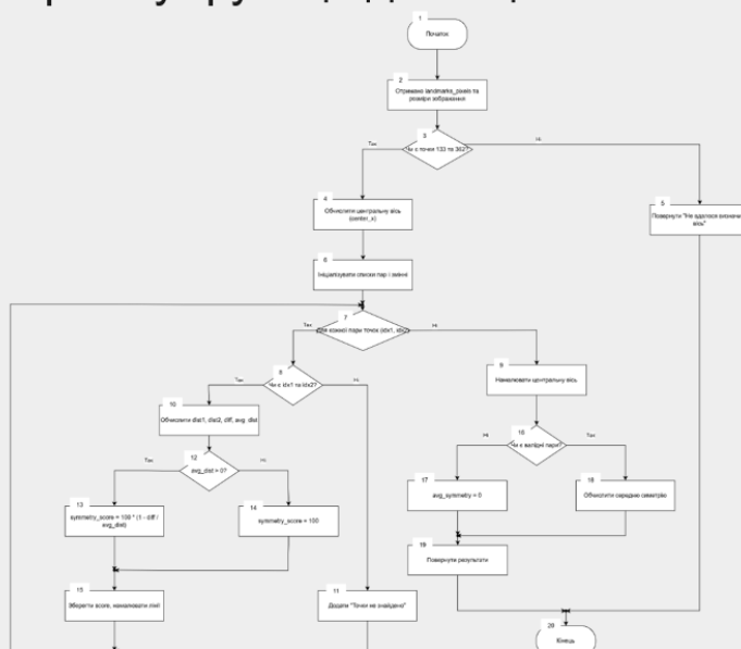
Рисунок Г.13 – Діаграма алгоритму функції для оцінки симетрії обличчя
