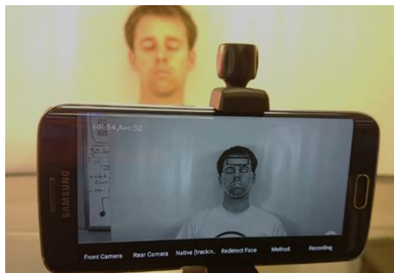
Рисунок 2.15 – Процес роботи відеоплетизмографії
