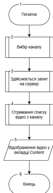
Рисунок 3.7 – Алгоритм отримання відео для вибраного каналу
