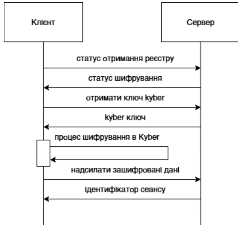
Рисунок 2.2 – UML діаграма застосування взаємодії клієнта і сервера для передачі ключа, захищеного постквантовим алгоритмом шифрування
