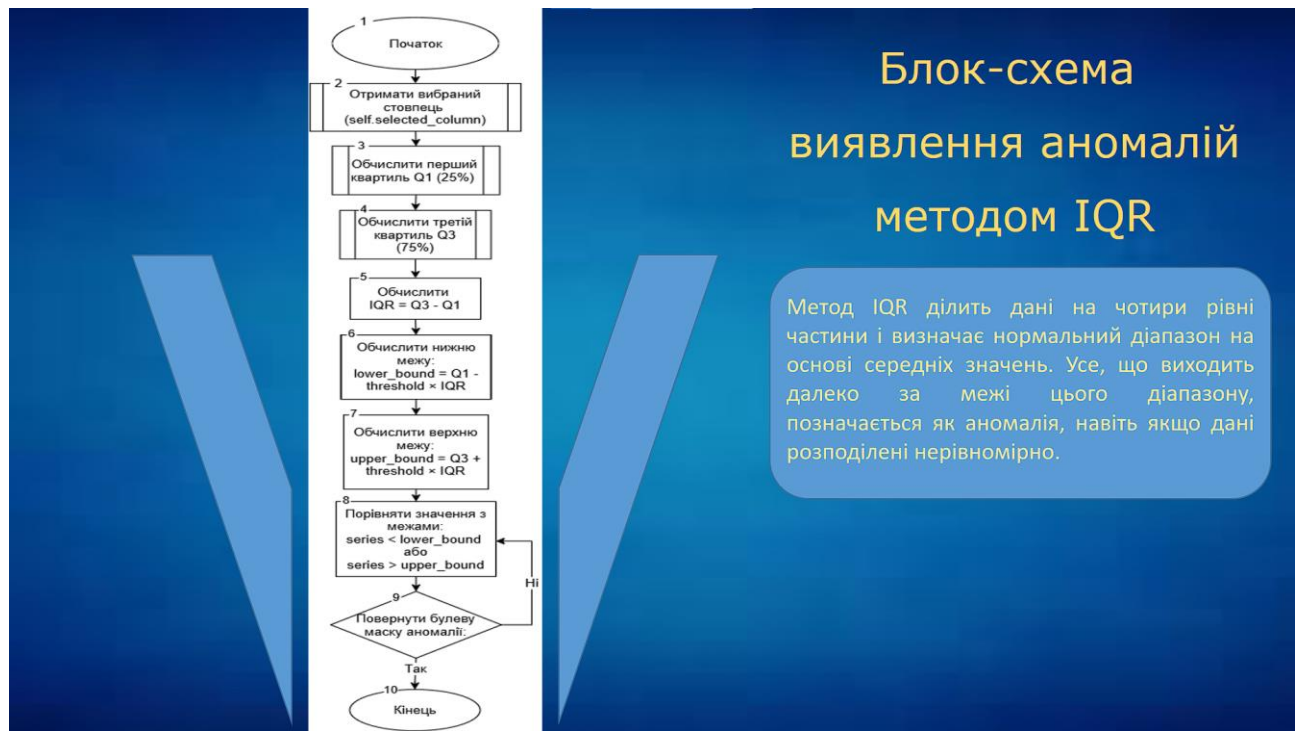
Рисунок Г.11 – Блок-схема виявлення аномалій методом IQR
