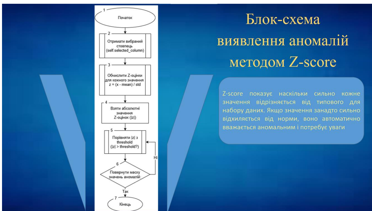
Рисунок Г.10 – Блок-схема виявлення аномалій методом Z-score
