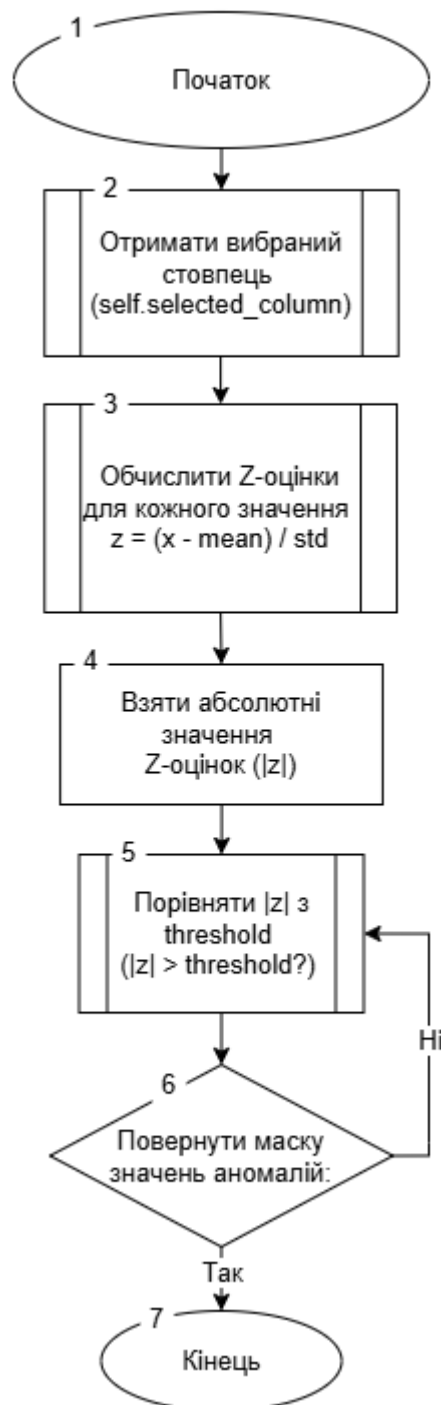
Рисунок 2.2 – Блок-схема алгоритму виявлення аномалій методом Z-score
