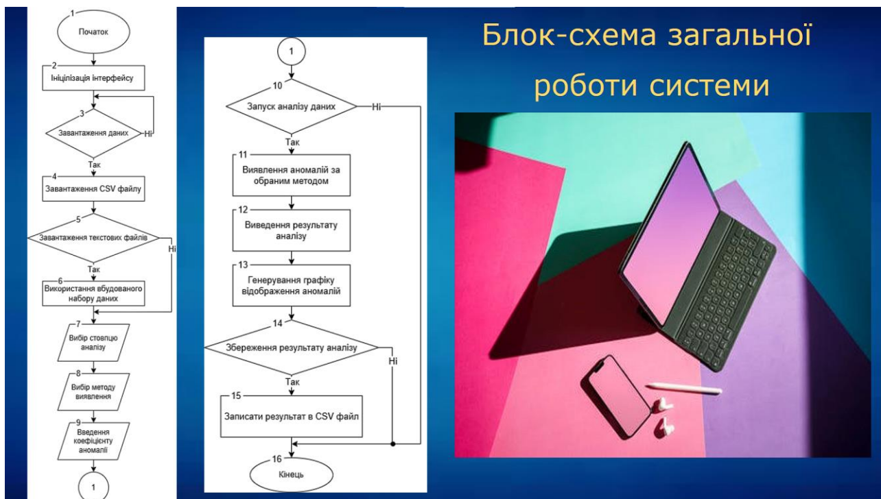
Рисунок Г.9 – Блок-схема загальної роботи системи
