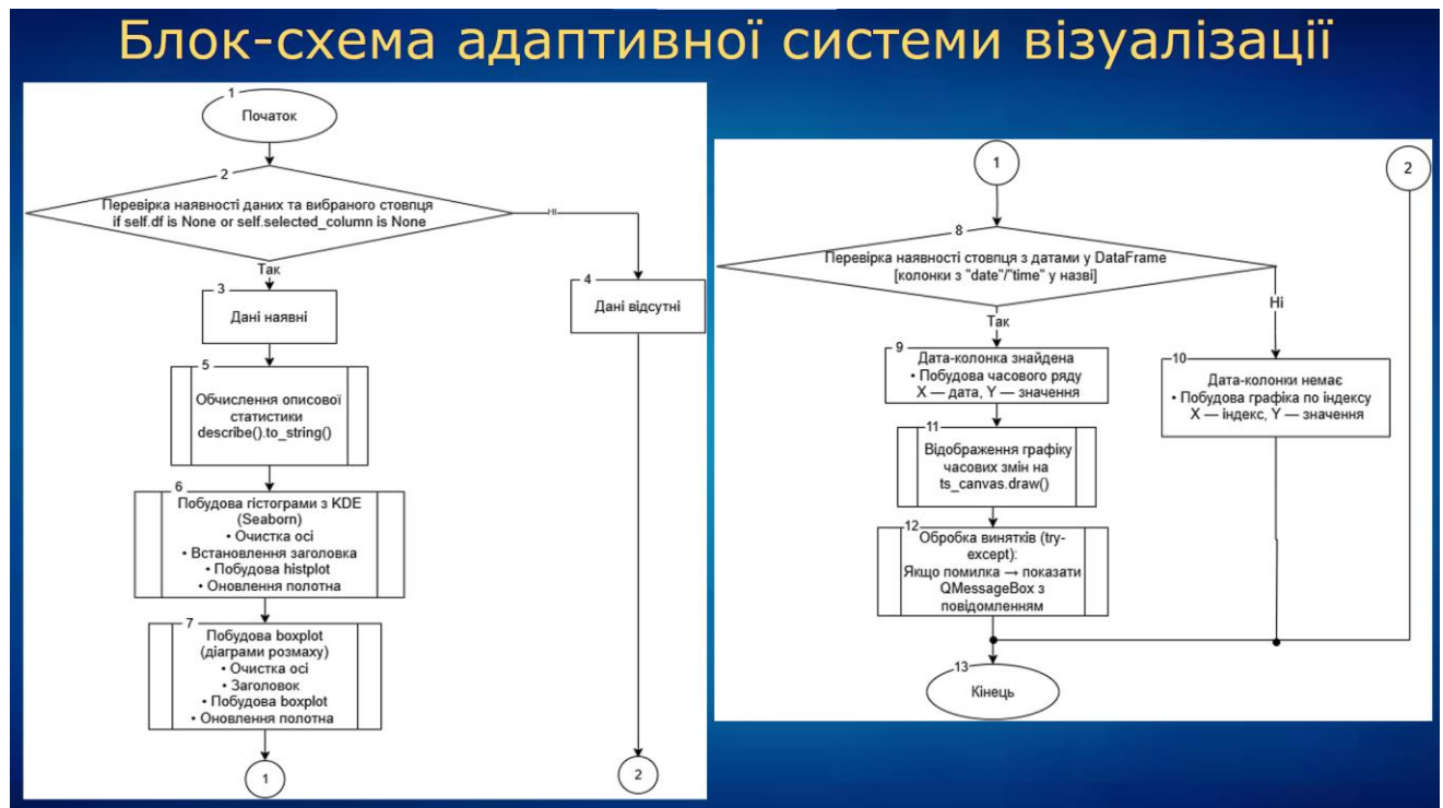
Рисунок Г.15 – Блок-схема адаптивної системи візуалізації
