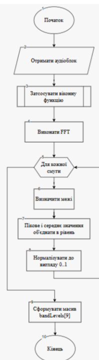
Рисунок Г.8 – Блок-схеми алгоритмів відображення рівня звуку за частотами та генерації хвильової форми
