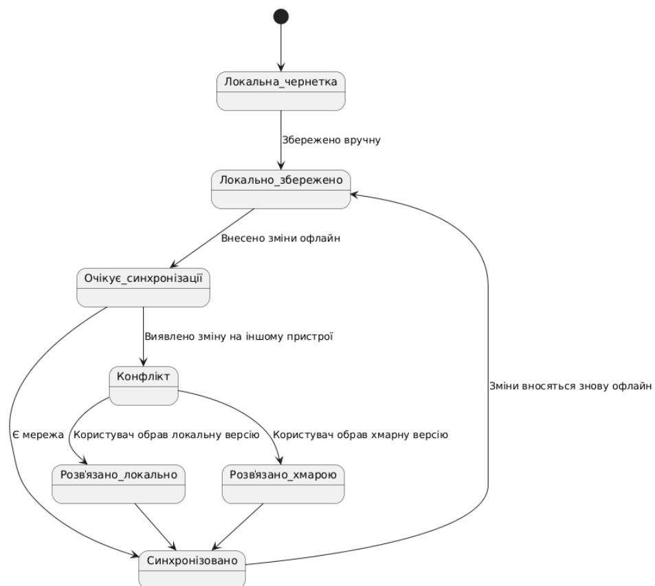
Рисунок 2.6 – Діаграма станів для процесу синхронізації нотатки
