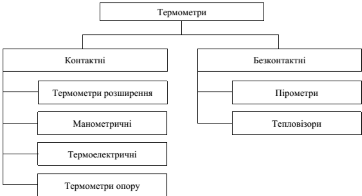
Рисунок А.1 – Класифікація засобів вимірювання температури
