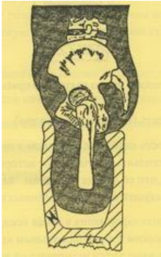
Рисунок4.9–Вакуумна гільза протеза стегна безконтактного дна
