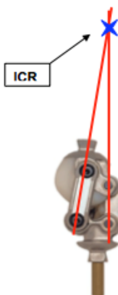
Рисунок 2.15 – Механізм поліцентричного колінного вузла
