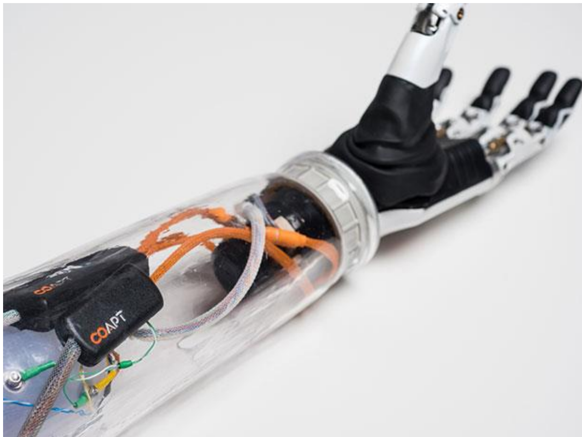
Рисунок 1.8 - Біонічний протез руки з системою Coapt
