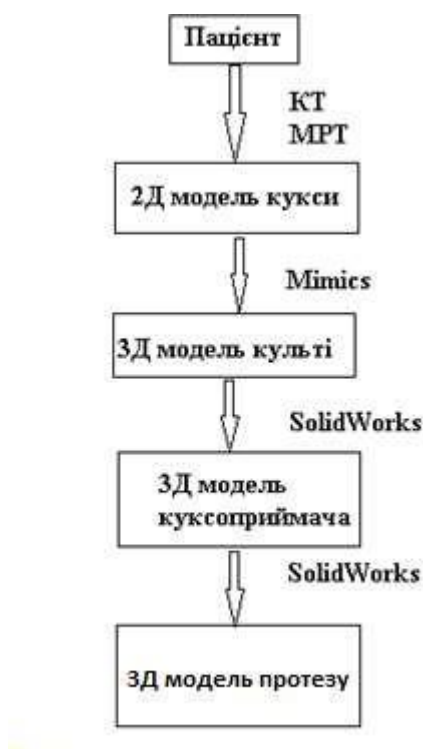
Рисунок 4.17 – Схематичне зображення технології формування цифрової 3D моделі
