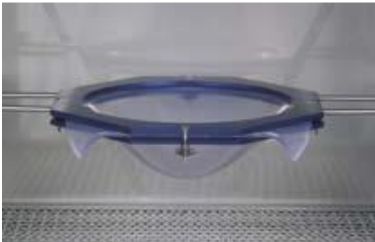
Рисунок 3.13 – Закріплення листової заготовки в затискній рамі пристрою глибокої витяжки
