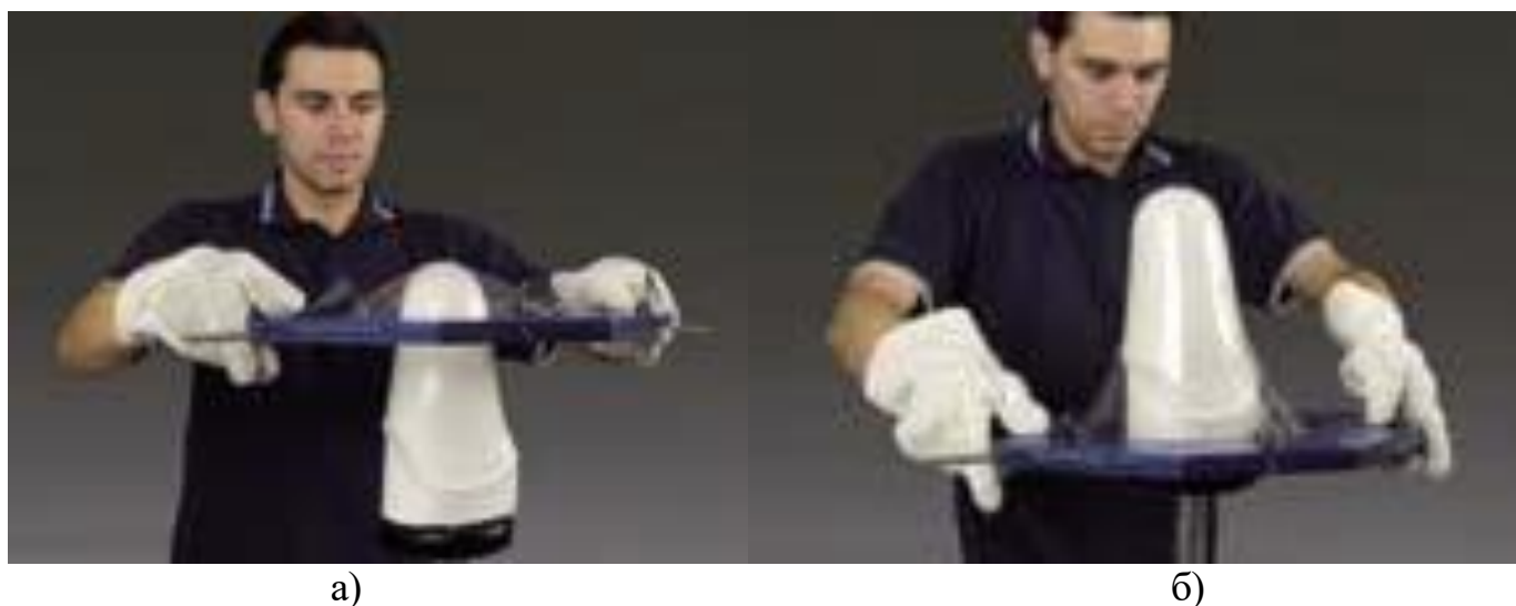
Рисунок 3.14 – Формування методом глибокої витяжки: а – переміщення затискної рами за моделлю; б – розміщення країв листової заготовки на ущільнюючій шайбі
